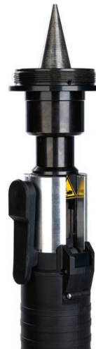
◀ Abb. 86: Montiertes Aufweitkopfwerkzeug.
