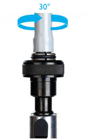
▲ Abb. 91: Bedienung der Antriebsmaschine. Das Rohr wird ausgeweitet.
