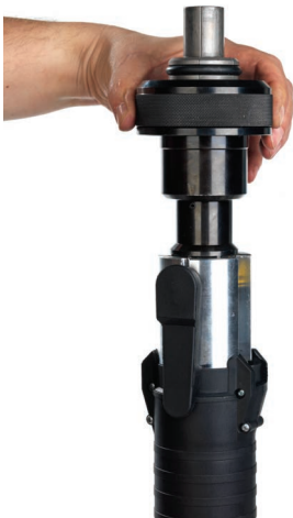
▲ Abb. 90: Montieren des Aufweitkopfs mit den Schrauben (Art. 15305)
