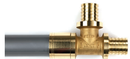
▲ Abb. 95: Fertige Schiebeverbindung - Hülse bis zur Flanschkante.
