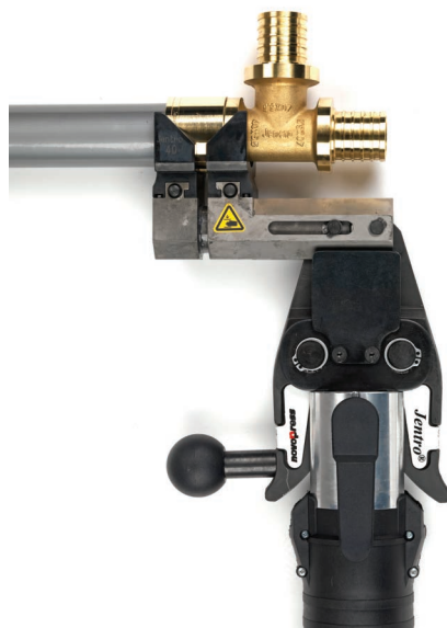
▲ Fig. 94: Utiliser la machine d'entraînement pour serrer le manchon à sertir jusqu'au col du raccord. Les deux têtes de serrage sont identiques.
