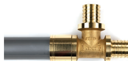
▲ Fig. 95: Manchon de jonction prêt. Douille jusqu'au bord de la bride.
