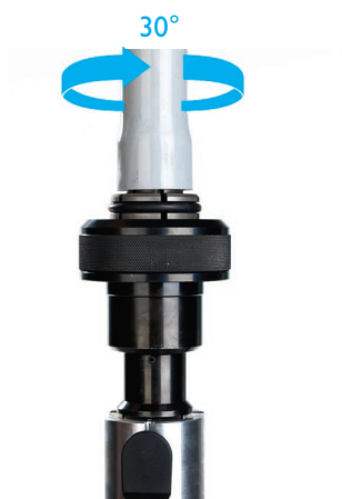
▲ Fig. 91: Utiliser la machine d'entraînement. Le tube est élargi. Répéter cette opération au moins deux fois (tourner de 30°).
