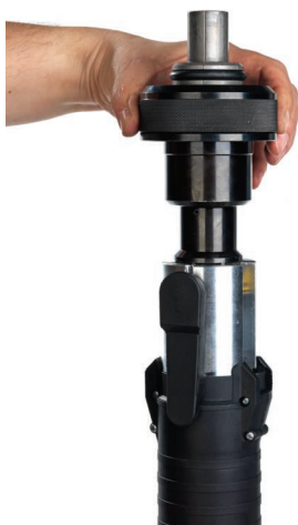
▲ Fig. 90: Monter la tête à expandre avec l'écrou (art. 15305).
