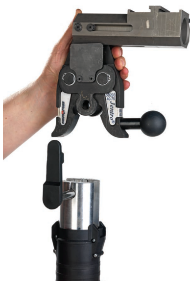
▲ Fig. 93: Enfiler les mâchoires de sertissage sur l'élément moteur compatible.
